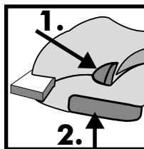
De machine steeds met uw beide handen vasthouden. De knop ter beveiliging tegen onbedoeld inschakelen indrukken (1). De AAN/UIT-schakelaar (2) indrukken.
